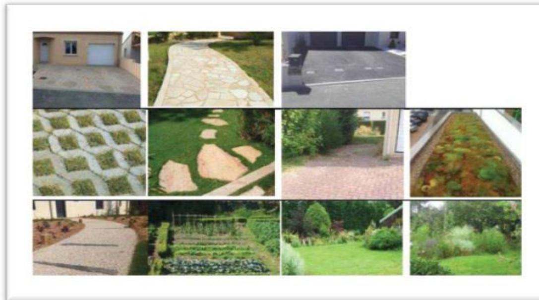
**Exemples de traitements permettant de limiter l'imperméabilisation**
